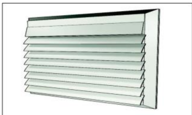
Figura 4: Grelha de fumaça
